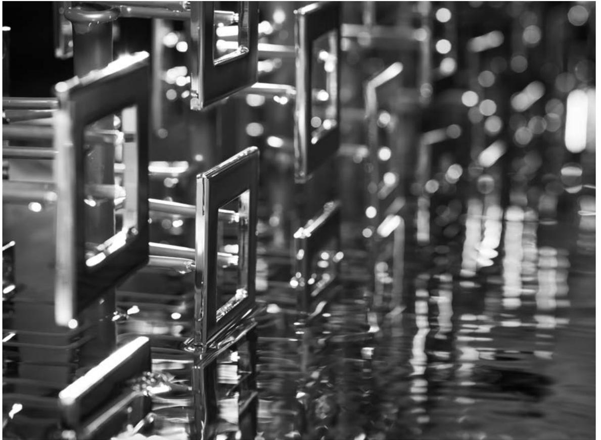
Die polierten Bauteile durchlaufen verschiedene Tauchbäder.
