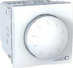
Светорегулятор поворотно-нажимной для ламп накаливания и галогенных ламп 230В и 12В с ферромагнитным трансформатором, переключатель                                                                              | 40-400Вт/ВА  | MGU3.511.18 | MGU3.511.25    | MGU3.511.30 | MGU3.511.12 |
