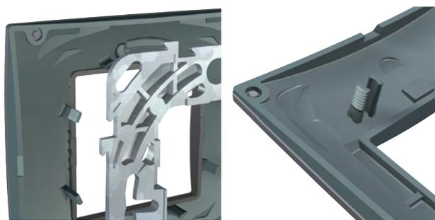
Рамки защелкиваются в четырех точках крепления простым надавливанием обеспечивая плотное прилегание даже при неровных стенах. Специальная система крепления позволяет установить рамки даже если коробка выступает из стены на 0,75 мм, или утоплена в стене на 2,25 мм.
